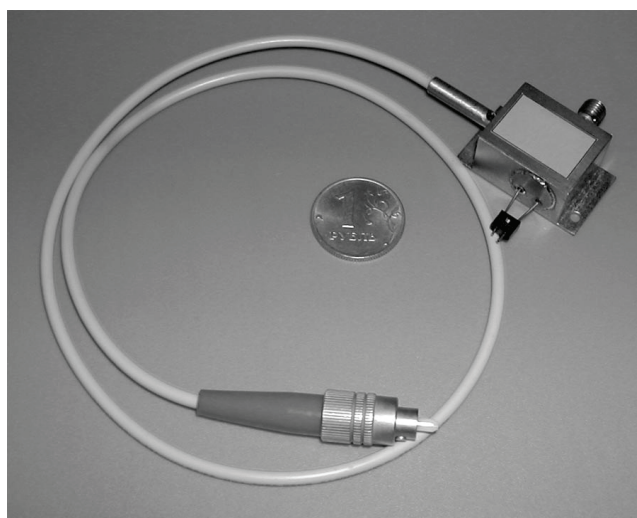
Рис. 6. Внешний вид приемного модуля ДФДМШ40-16 с оптическим волокном диаметром 3 мм
