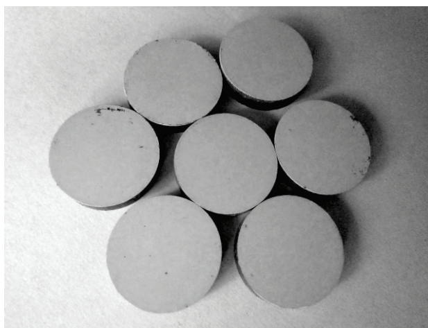
Рис. 2. Прессованные диски из AlN гранулята
