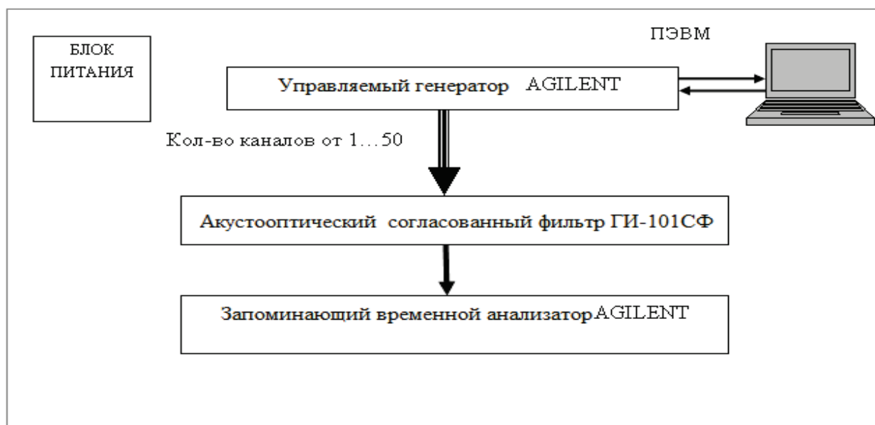
Рис. 3. Структура стенда акустооптического согласованного фильтра ГИ-101СФ
