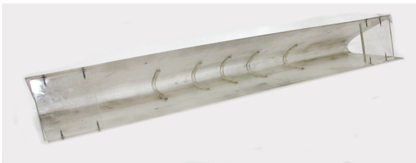
Снимок экспериментального обтекателя из оргстекла
