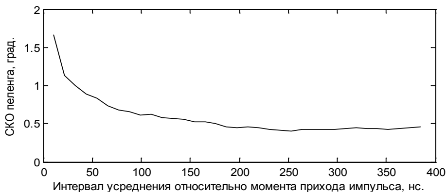
Рис. 4. Зависимость СКО пеленга от интервала усреднения относительно момента прихода, трасса №2, сектор углов антенны РЛС \pm 180^\circ
